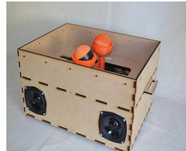
Structure du dispositif, Tala Box, (Hard) 158 x 454 X 340 mm, Raspberry Pi3, écran de contrôle, ampli audio, 2 haut-parleurs et 2 rails linéaires motorisés, 4 moteurs pas à pas, Arduino, Shield CNC. Impressions 3D/PLA, (Soft) traitement signal Python, Librairie Librosa. Boîte HDF et recouvert de Néoprène.
