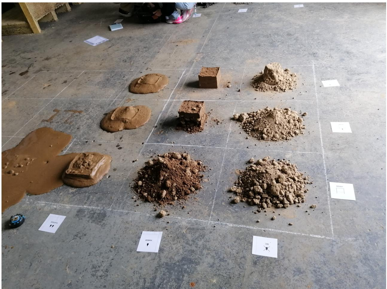
**Fig. 3 : Test de Carazas réalisé avec les étudiants du M1 Design situé, milieux et matériaux en 2023. (matériel pédagogique proposé par AMàCO à commander en ligne<sup>17</sup>).**
