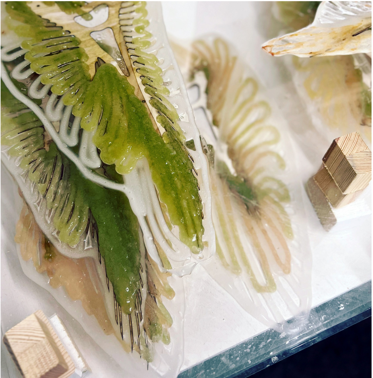
Fig 2 et 3 : Impression d'hydrogels pour la fabrication de structures bio-réceptives, accueillants micro-organismes et bactéries, pour des applications architecturales. Mené par Bastian Beyer, Li Tairan et Daniel Suárez au Cluster d'Excellence « Matters of Activity » de l'Université de la Humboldt à Berlin, 2023.
